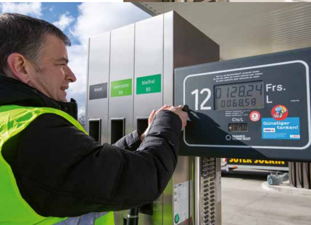
Die Information über die getankte Menge wird an das Rechenwerk oben an der Säule übertragen. Hier befindet sich der Computer, der die gesamte Säule steuert. Dieser berechnet den Gesamtpreis der Tankfüllung und sperrt nach dem Tankvorgang die Säule so lange, bis das Kassensystem die Bezahlung bestätigt. Ebenfalls erledigt der Computer die sogenannte Temperaturkompensation. Da Treibstoff bei unterschiedlichen Temperaturen eine unterschiedliche Ausdehnung hat und man nach Volumen bezahlt, wird die getankte Menge immer auf das Volumen bei 15 Grad Celsius umgerechnet.
