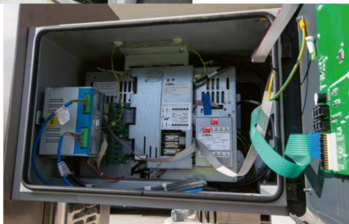
Die Information über die getankte Menge wird an das Rechenwerk oben an der Säule übertragen. Hier befindet sich der Computer, der die gesamte Säule steuert. Dieser berechnet den Gesamtpreis der Tankfüllung und sperrt nach dem Tankvorgang die Säule so lange, bis das Kassensystem die Bezahlung bestätigt. Ebenfalls erledigt der Computer die sogenannte Temperaturkompensation. Da Treibstoff bei unterschiedlichen Temperaturen eine unterschiedliche Ausdehnung hat und man nach Volumen bezahlt, wird die getankte Menge immer auf das Volumen bei 15 Grad Celsius umgerechnet.
