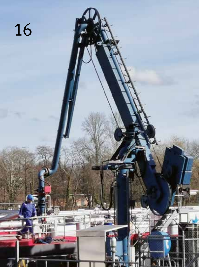
Die Benzinfracht des Tankschiffs «Stadt Aschaffenburg» wird im Auhafen über den mächtigen Teleskoparm gelöscht.
